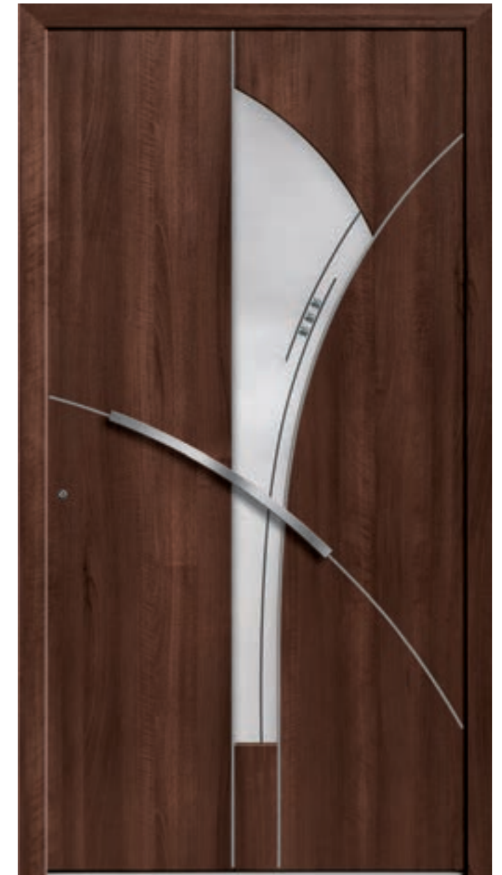
Modell 73500 | Aufsatzfüllung Glas G-1223 mattiertes Glas mit klaren Streifen und Glassteinen Griff Integrierter Designgriff V-80 Edelstahl Farbe Nussbaum Modell in Kunststoff und Aluminium RC2 geeignet Modell in Aluminium RC3 geeignet
