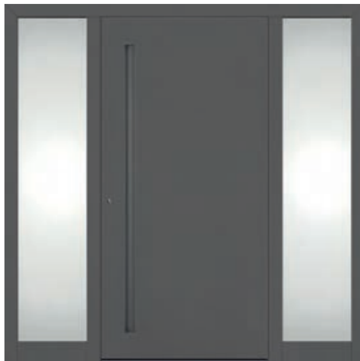
Modell 74800 | Aufsatzfüllung mit 2 Seitenteilen Glas Ganzglasseiteile Satinato weiß Griff Schüco Design-Griffschale optional mit indirekter LED-Beleuchtung | inkl. Netzteil 24 V Farbe Finea 04 Modell in Kunststoff und Aluminium RC2 geeignet
